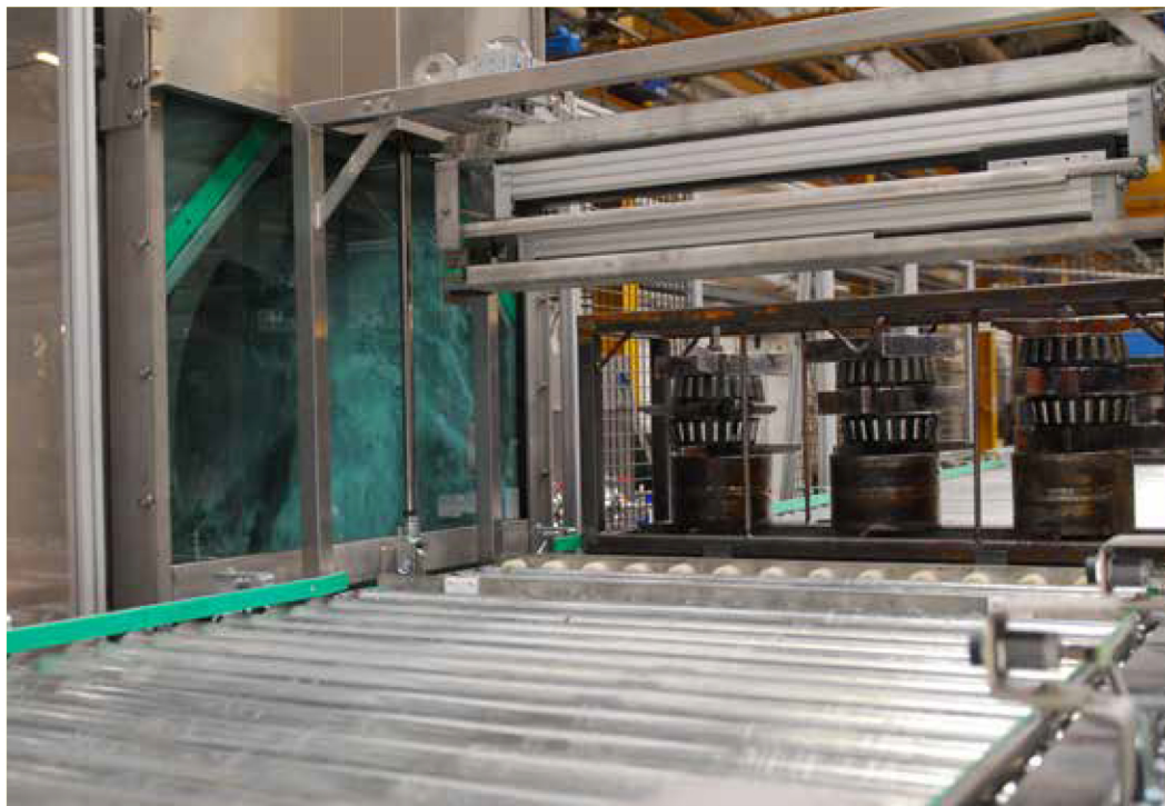
Vollautomatischer Ablauf. Die Körbe mit den verschmutzten Lagerteilen werden über eine rollengeführte Aufnahmeverrichtung weiterbefördert. Das Ein- und Ausfahren in die Reinigungskammer erfolgt vollautomatisch.
