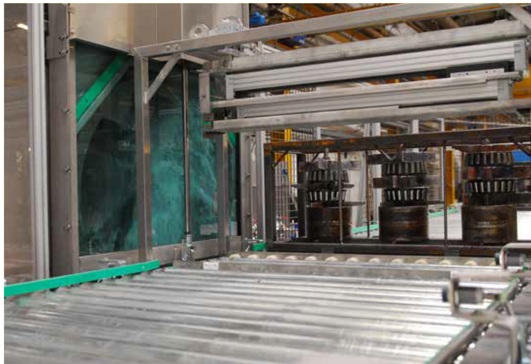
Vollautomatischer Ablauf. Die Körbe mit den verschmutzten Lagerteilen werden über eine rollengeführte Aufnahmevorrichtung weiterbefördert. Das Ein- und Ausfahren in die Reinigungskammer erfolgt vollautomatisch
