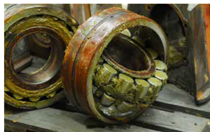
Echt fett. Bevor es an die Aufarbeitung geht, müssen die Lager erstmals gründlich von Schmutz und Fett befreit werden
