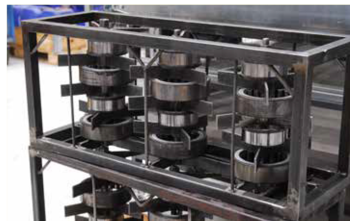
Gut verpackt. Bis zu neun Lagerteile können in den Waschkörben gestapelt werden. Damit werden sie durch die Anlage geschleust
